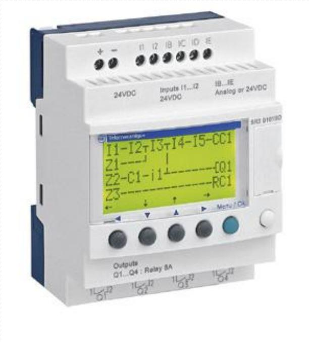
Es decir, en un solo bloque se encuentran la CPU, la fuente de alimentación, la sección de entradas y salidas, y el puerto de comunicación, este tipo de PLC se utiliza cuando nuestro proceso a controlar no es demasiado complejo y no requerimos de un gran número de entradas y/o salidas ó de algún módulo especial.
