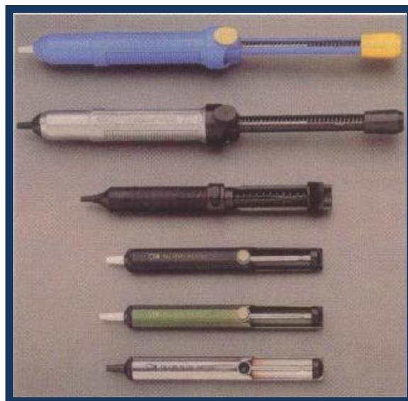
Existen varios métodos para retirar la soldadura de los pines de un componente. El más popular consiste en emplear el desoldador, el cual tiene un sistema mecánico que genera un vacío que le permite absorber o extraer la soldadura que se ha derretido previamente con el cautín.
