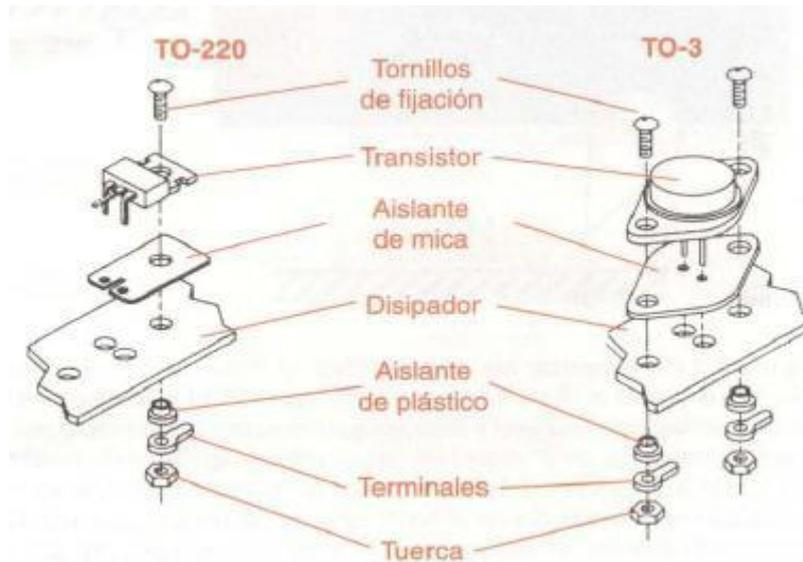
En algunos circuitos los transistores pueden ir montados sobre el circuito impreso incluyendo un disipador más pequeño. Estas indicaciones se pueden asimilar también para los SCR 's, Triacs y reguladores de voltaje integrados que tienen la misma forma, generalmente del tipo TO-220.
