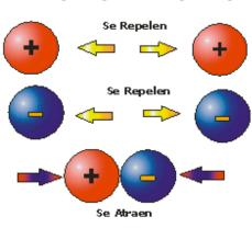
LA CARGA ELÉCTRICA de un electrón o un protón se llama electrostática. Las líneas de asociadas en cada partícula producen un campo electrostático. Debido a la forma en que interactúan estos campos, las partículas pueden atraerse o repelerse entre si. La ley de las cargas eléctricas dice que las partículas que tienen cargas iguales se repelen y las que tienen cargas opuestas se atraen.
